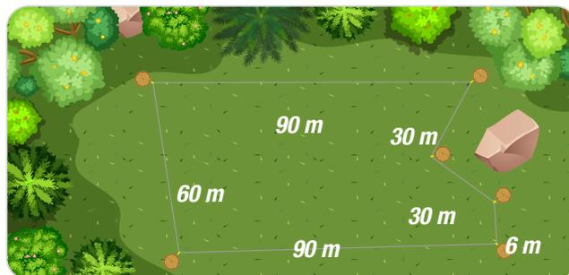
Diese Weide misst 306 m und beinhaltet ein Tor, außerdem muss ein großer Felsen umgangen werden. Daher werden 6 stabile Eckpfosten benötigt. Für die teilweise langen Strecken zwischen den Pfosten sollten Streckenpfähle mit einem Abstand von 3 m gesetzt werden, die 3 Ebenen Breitband auf Höhe halten (weitere Pfahlabstände S. 18). Bei einer Zaunlänge von 300 m werden somit 100 Streckenpfähle benötigt, ausgenommen davon ist die Länge des Tores (hier 6 m unterhalb des Felsens).
