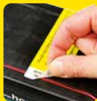
Die alkalische Batterie aktiviert sich erst bei der Kontaktnahme mit Sauerstoff. Vor Anschluss an das Weidezaungerät muss bei der alkalischen Batterie unbedingt der Aufkleber auf dem Deckel vollständig entfernt werden, um die Kontaktaufnahme mit Sauerstoff zu aktivieren.
