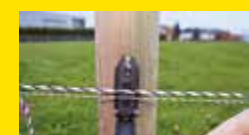
Connexion entre 2 hauteurs de conducteurs par des câbles
