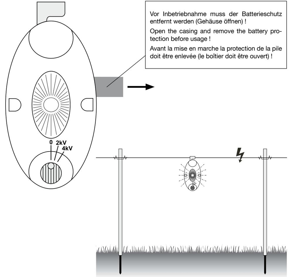
Vor Inbetriebnahme muss der Batterieschutz entfernt werden (Gehäuse öffnen) !
